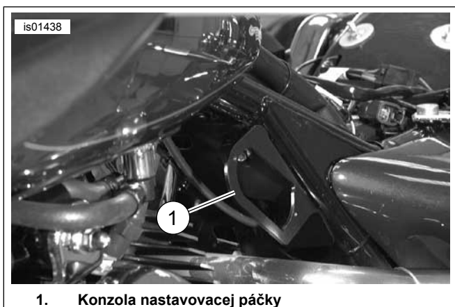
Obrázok 2. Namontovaná konzola nastavovacej páčky
