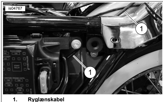
Figur 10. Kabelføring af ryglæn
