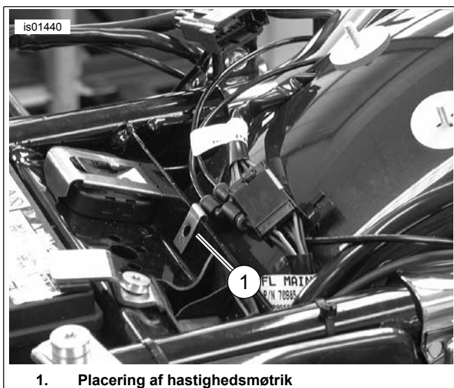
Figur 4. Montering af hastighedsmøtrik
