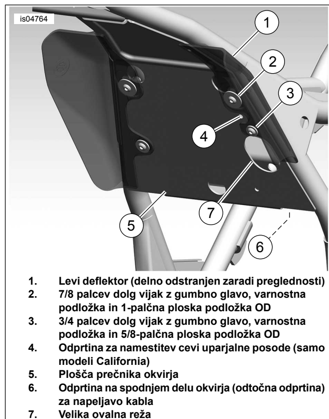
Slika 5. Modeli 2008: Mesta pritrtilnih elementov - Pogled na del okvirja za glavnim valjem (motor je odstranjen zaradi preglednosti)
