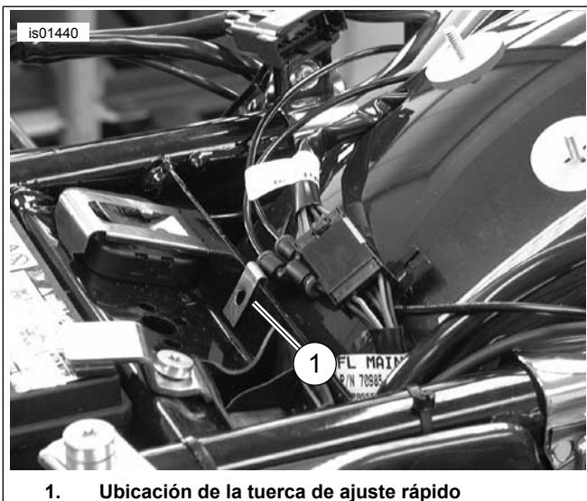
Figura 4. Instalación de la tuerca de ajuste rápido
