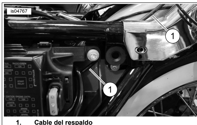
Figura 10. Ubicación del cable del respaldo
