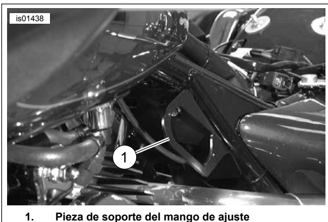
Figura 2. Pieza de soporte del mango de ajuste instalado
