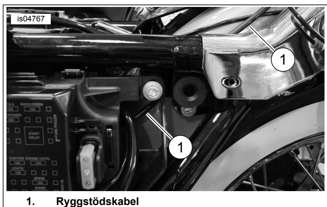
Figur 10. Dragning ryggstöds kabel
