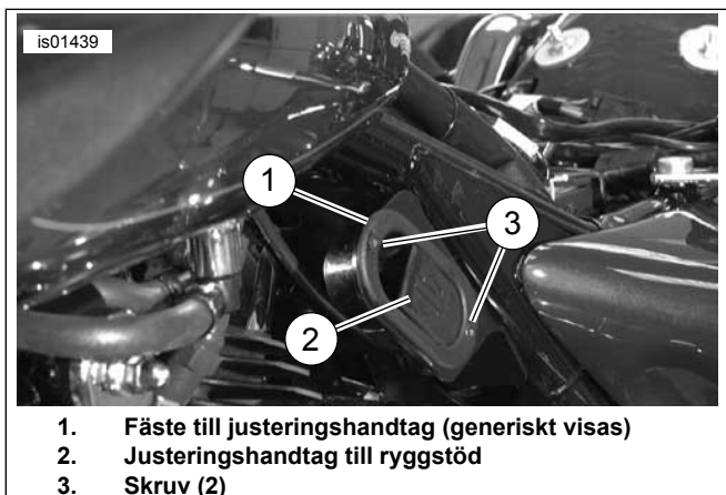
Figur 3. Monterat justeringshandtag för ryggstöd
