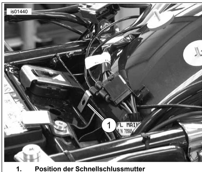
Abbildung 4. Installation der Schnellschlussmutter
