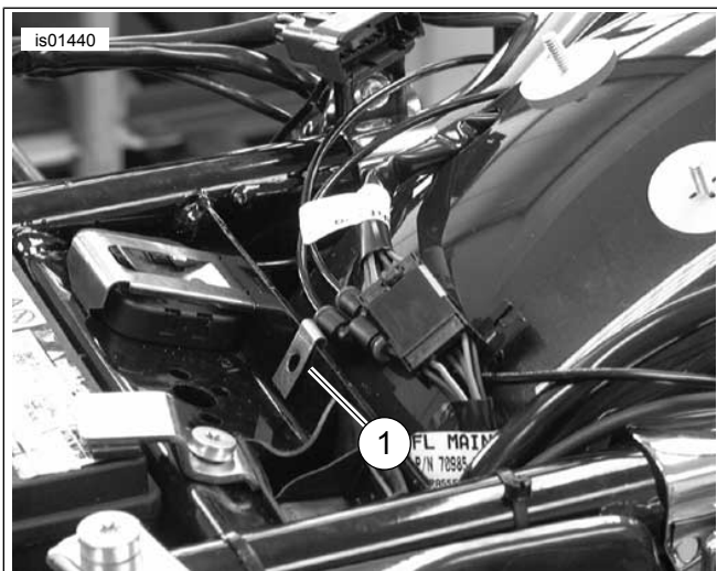
1. Θέση οδοντωτού μεταλλικού παξιμαδιού
