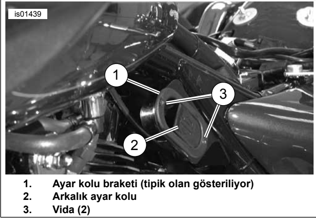
Şekil 3. Takılmış Arkalık Ayar Kolu
