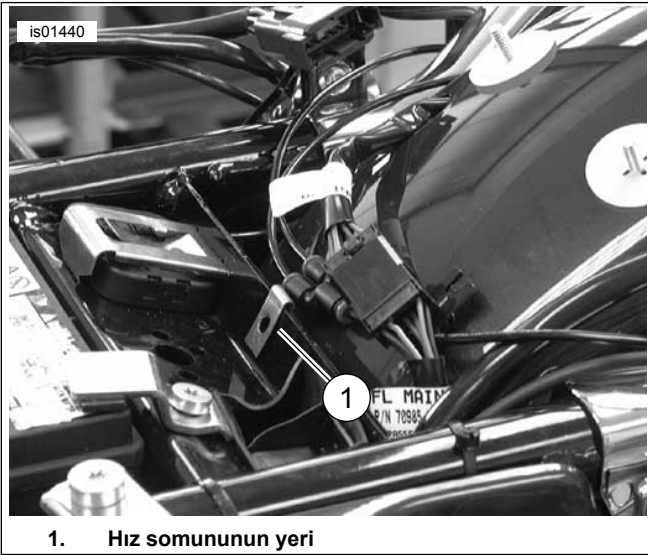
Şekil 4. Hız Somununun Takılması
