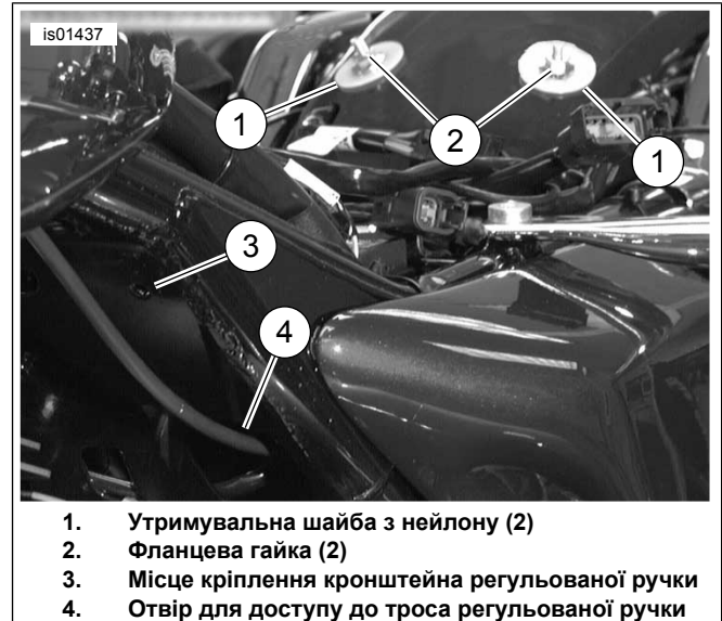
Малюнок 1. Зняття фланцевих гайок/Розташування кронштейна
