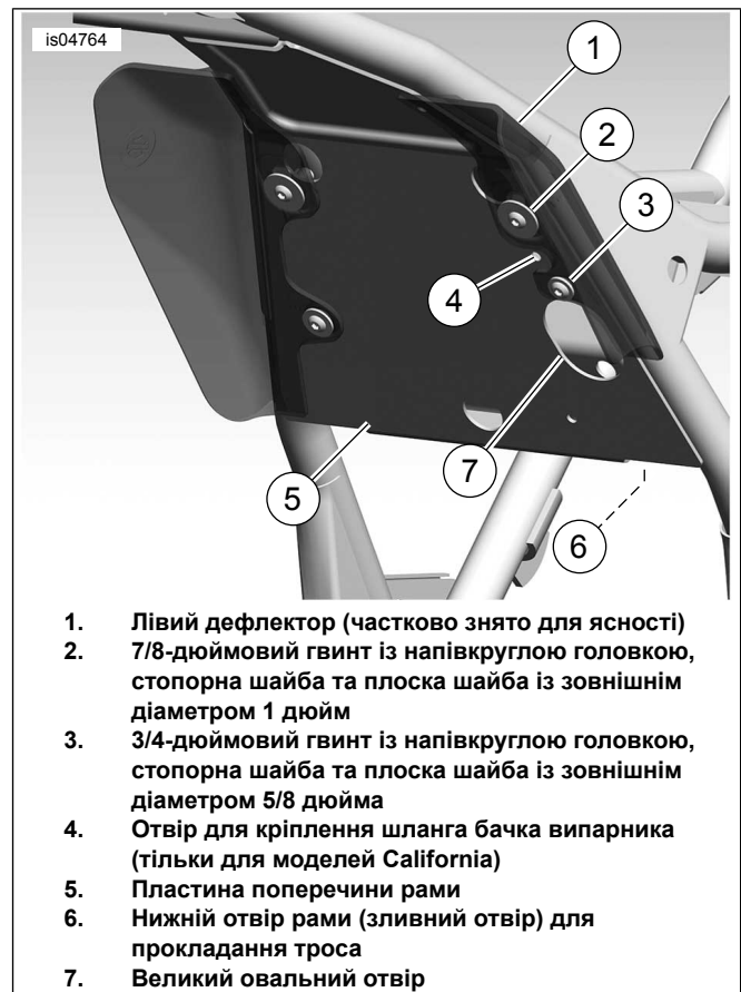
Малюнок 5. Для моделей 2008 р.: Місця кріплення – вид рами ззаду від заднього циліндра (двигун знято для ясності)
