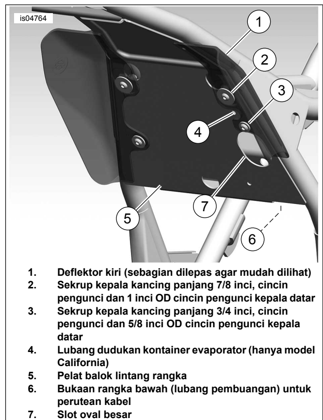
Gambar 5. Model 2008: Lokasi Pengencang - Tampilan Belakang Rangka dari Silinder Belakang (Mesin Dilepas Agar Mudah Dilihat)
