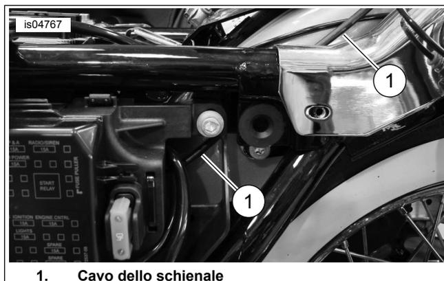
Figura 10. Disposizione del cavo dello schienale
