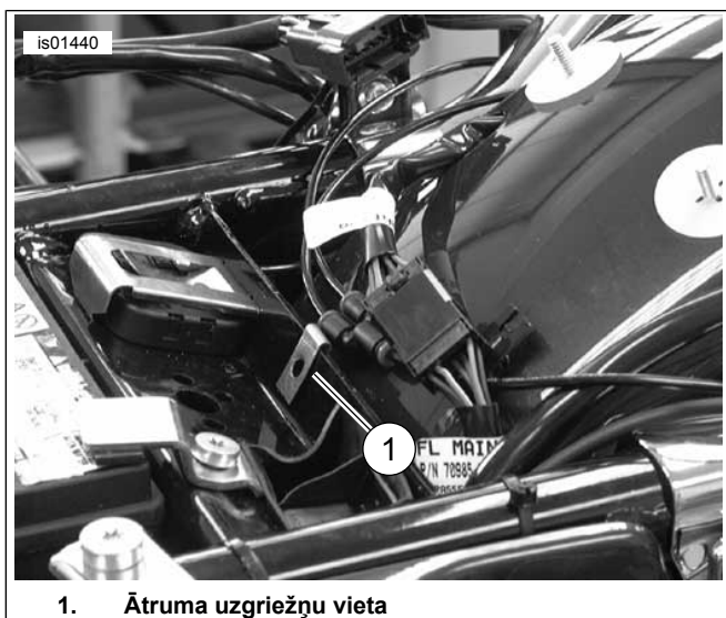
Attēls 4 Uzstādiat ātruma uzgriezni
