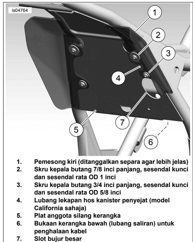
Rajah 5. Model 2008: Lokasi Pengetat - Pandangan Kerangka Dari Belakang Silinder Belakang (Enjin Ditanggalkan agar Lebih Jelas)
