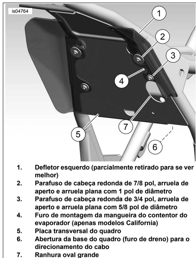
Figura 5. Modelos 2008: Locais de fecho - Vista da retaguarda do quadro do cilindro traseiro (o motor foi retirado para se ver melhor)
