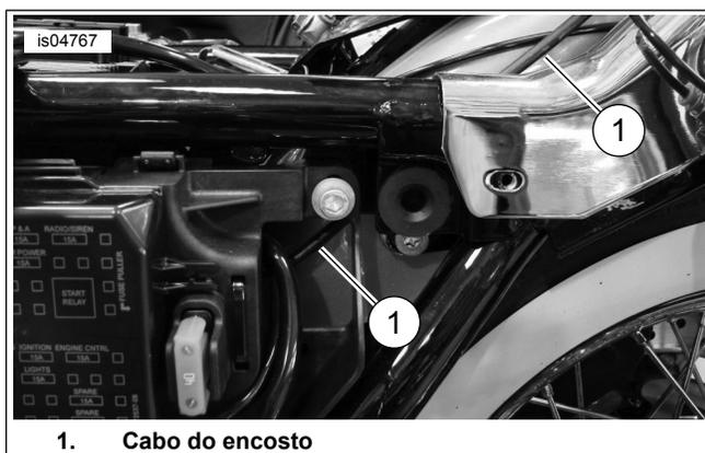
**Figura 10. Direcionamento do cabo do encosto**
