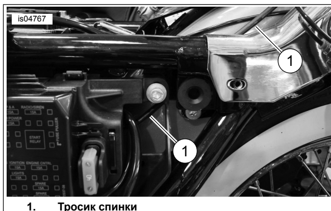
Рисунок 10. Разводка тросика спинки
