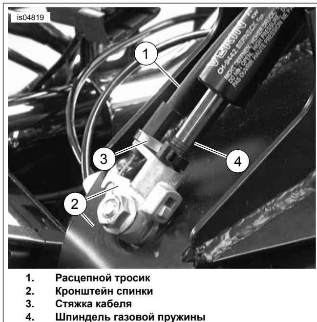
Рисунок 11. Прикрепление тросика к кронштейну спинки
