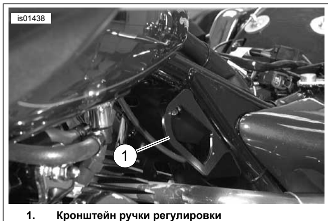
Рисунок 2. Установленный кронштейн ручки регулировки
