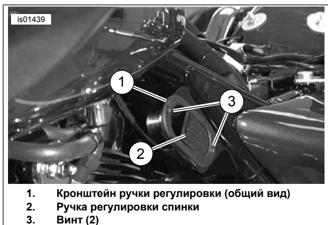
Рисунок 3. Установленная ручка регулировки спинки
