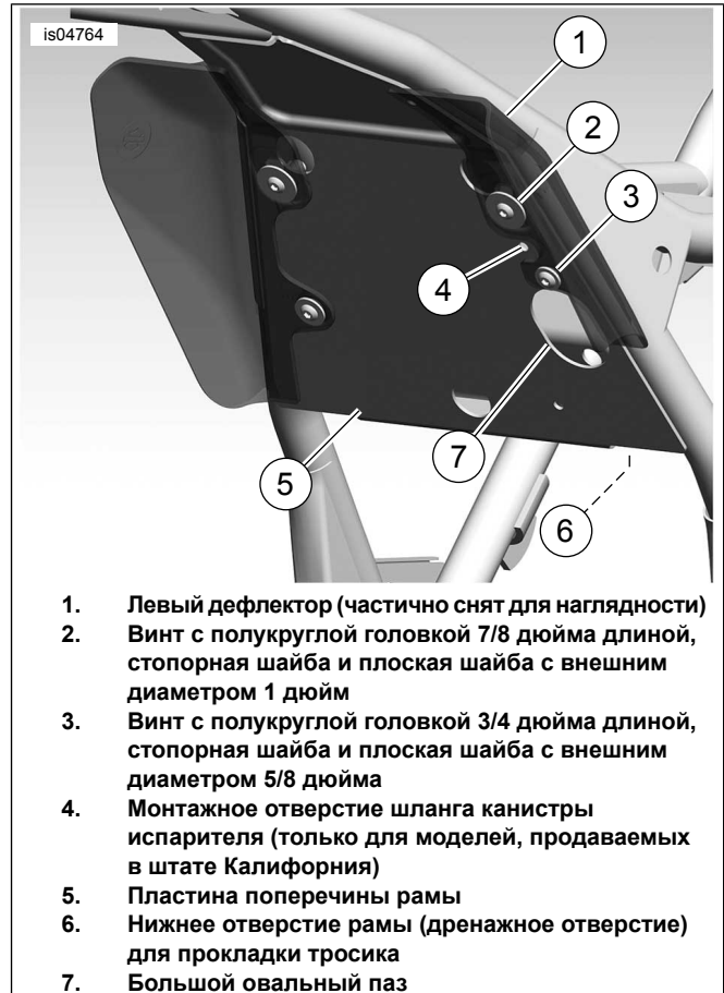
Рисунок 5. Модели 2008 года выпуска: Расположение крепления: вид рамы за задним цилиндром (двигатель снят для наглядности)
