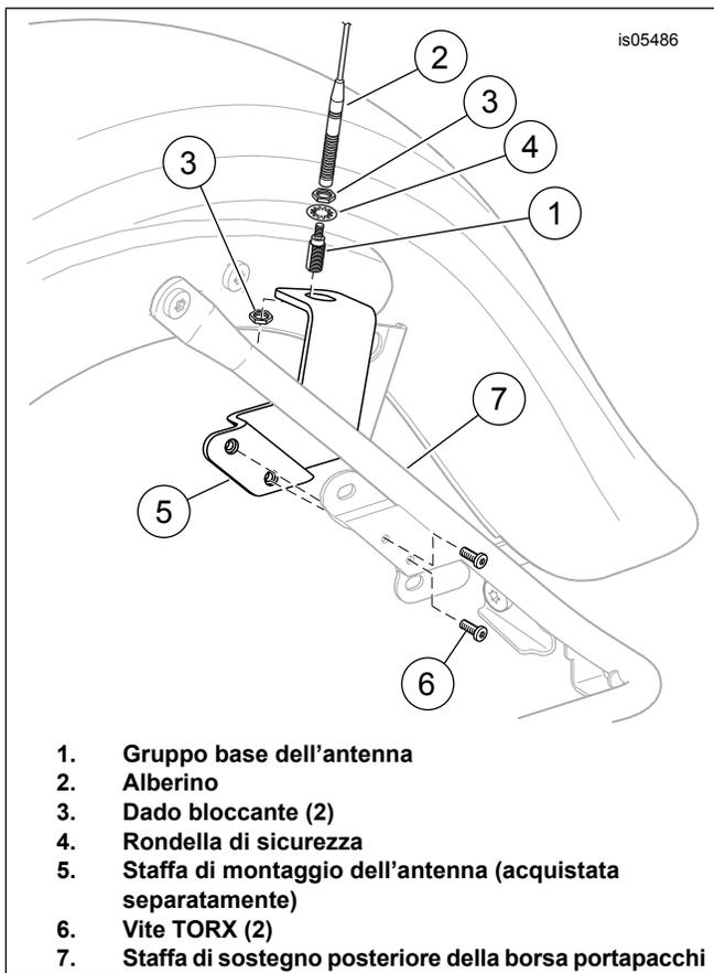
**Figura 2. Staffa di montaggio dell'antenna**
