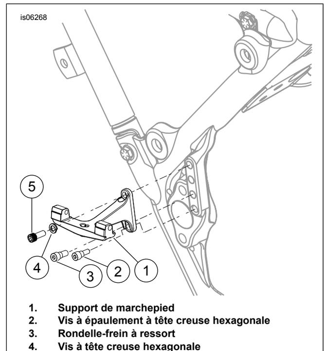
Figure 1. Installation du support de marchepied
