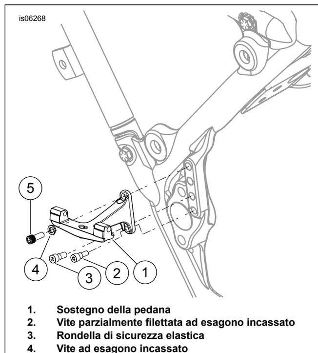
Figura 1. Installazione del sostegno della pedana
