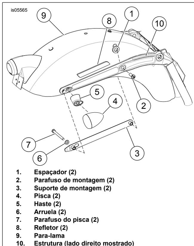
Figura 1. Remover os componentes do para-lama
