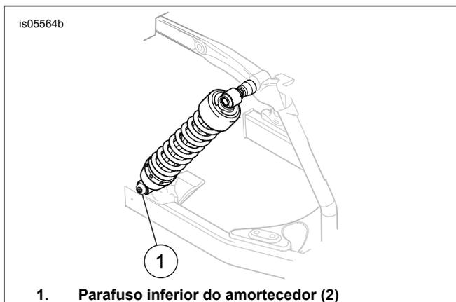
**Figura 2. Remova o parafuso inferior do amortecedor (lado direito mostrado)**
