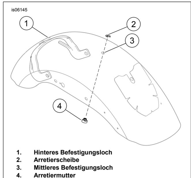
Abbildung 1. Schutzblechbefestigungslöcher
