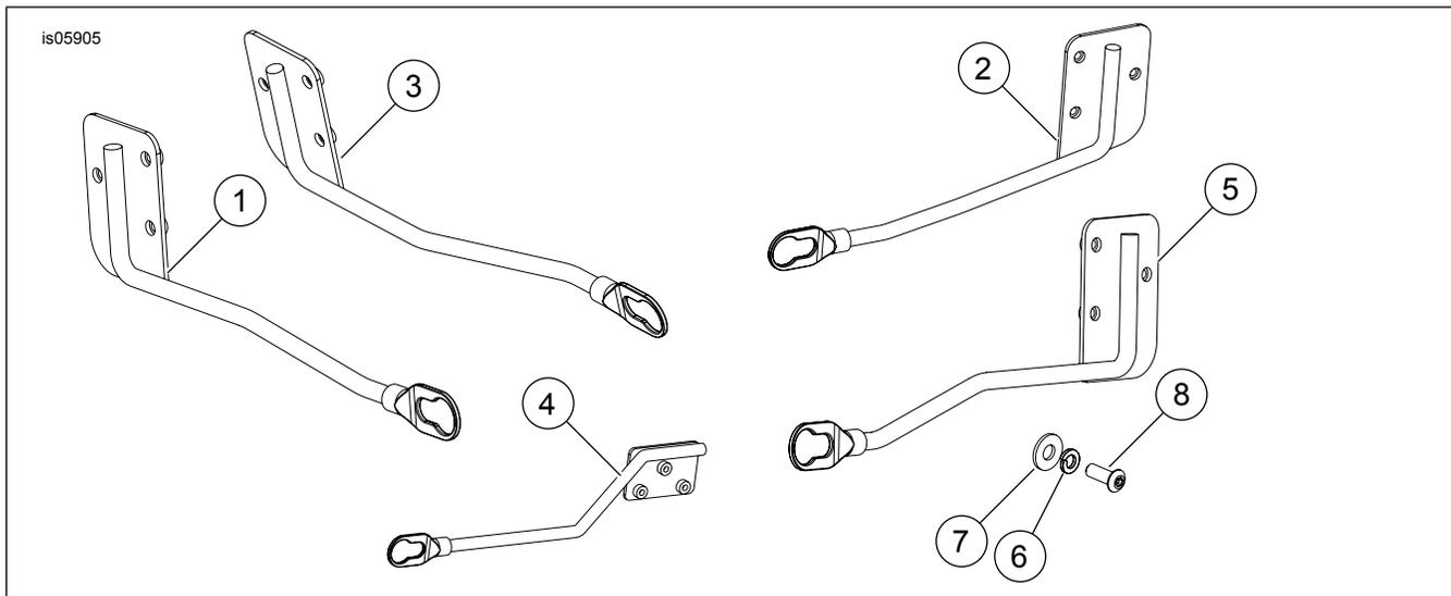
Abbildung 1. Ersatzteile: Satz mit unterer Stützhalterung für abnehmbare Satteltaschen
