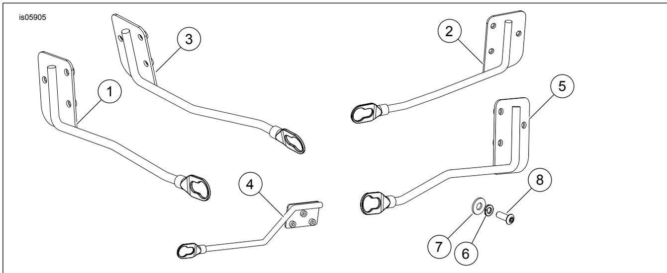
Figura 1. Parti di ricambio: kit staffa di sostegno inferiore della borsa portapacchi rimovibile
