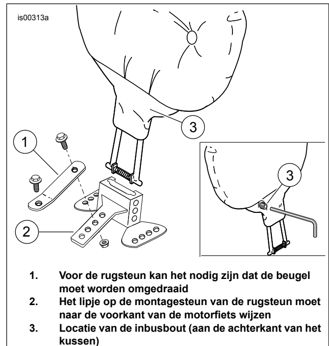
Afbeelding 1. Positie van de steun en beugel van de rugsteun
