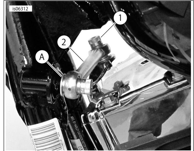
図2。スタビライザーリンク用の交換パーツ
