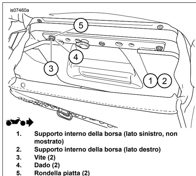
Figura 4. Installazione bulloneria temporanea con kit borsa rimovibile (90200641)
