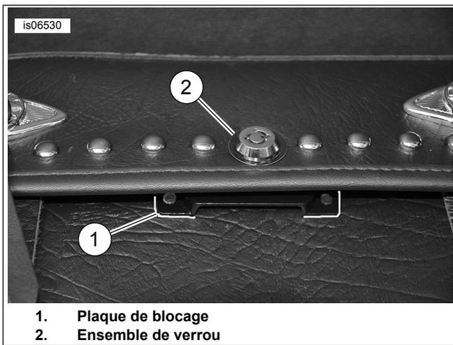
Figure 5. Positionnement de la plaque de verrouillage
