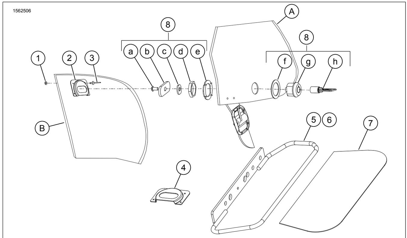
Figure 6. Pièces de rechange : Kit sacoches Heritage Flat Top et verrou
