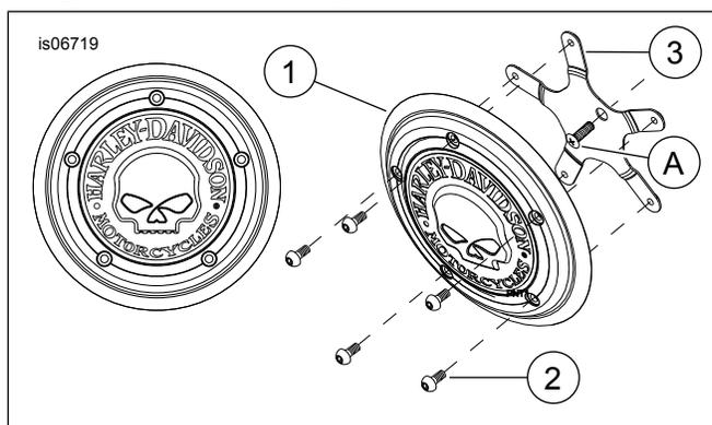
Figura 1. Guarnição do filtro de ar, skull, tampa redonda
