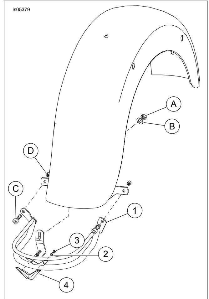
Figure 1. Pièces de rechange : Longeron de garde-boue arrière avec logo V
