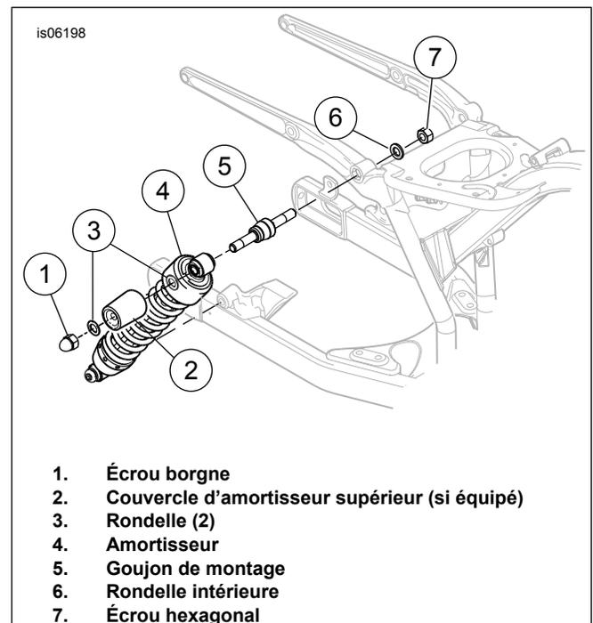
Figure 1. Retirer l'amortisseur arrière (typique)
