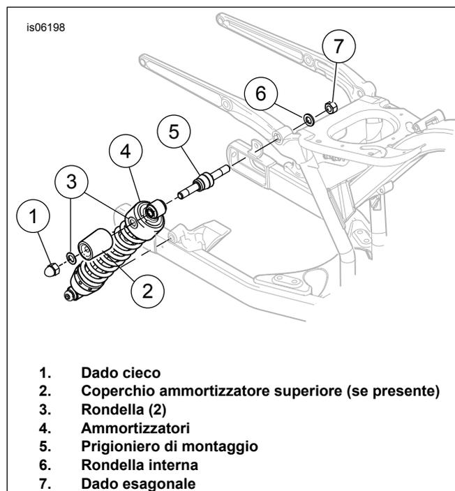
Figura 1. Rimuovere l'ammortizzatore posteriore (tipico)
