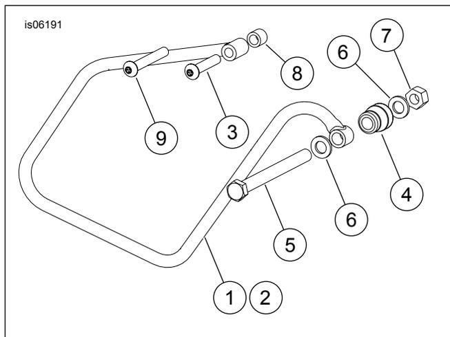
Figura 3. Parti di ricambio: Kit sostegno della borsa portapacchi
