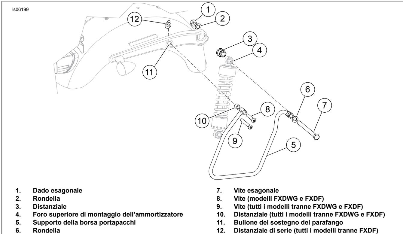
**Figura 2. Installazione del sostegno della borsa portapacchi**
