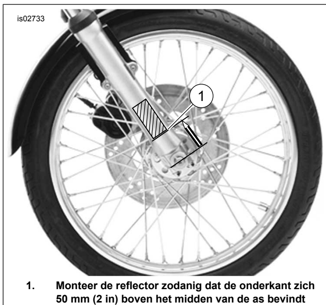
Afbeelding 1. Plaatsen van de reflector
