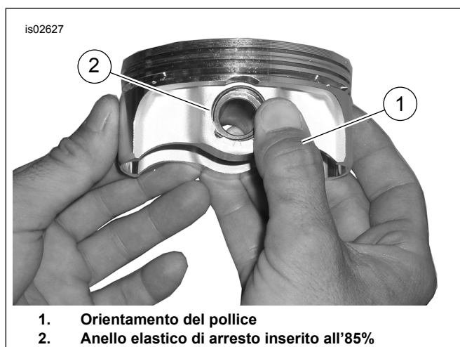
Figura 3. Installazione anello elastico di arresto (mostrato pistone generico)
