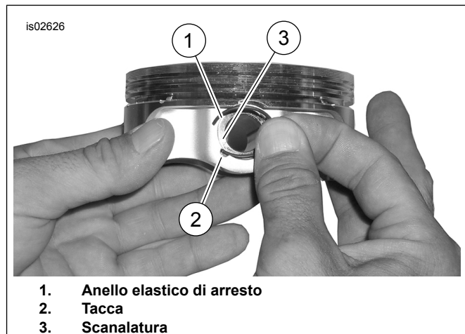
Figura 2. Anello elastico di arresto e pistone (mostrato pistone generico)
