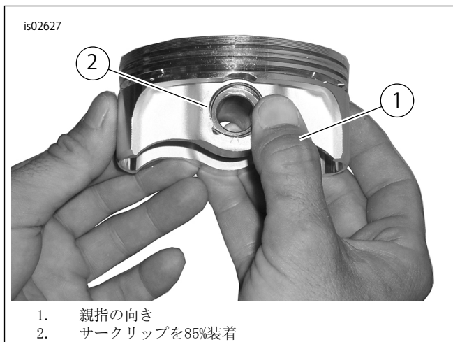
図3。サークリップの取り付け(写真は一般的なピストン)
