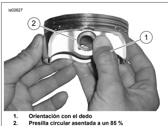
**Figura 3. Instalación de la presilla circular (se muestra un pistón genérico)**
