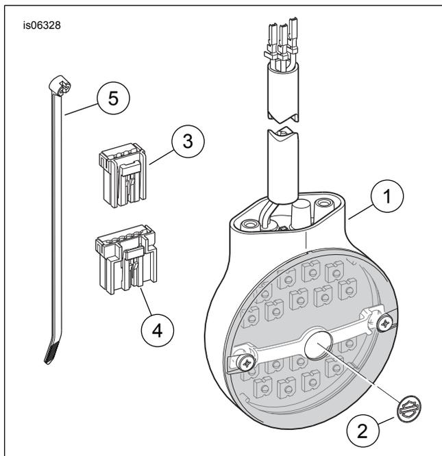
Figure 1. Pièces de rechange, kits de feu de direction avant à DEL à diffuseur plat
