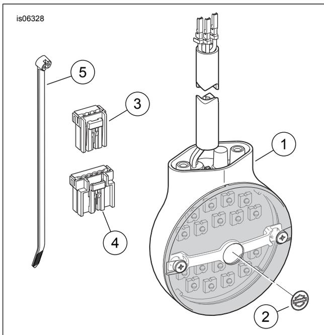
Figura 1. Peças de reposição, kits de lâmpada de LED do pisca dianteiro com lente achatada
