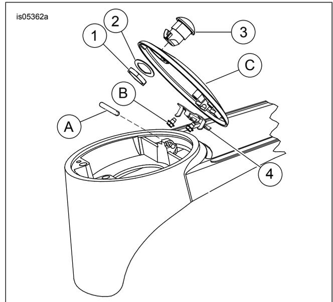
Abbildung 2. Ersatzteile: Tankkonsolenklappen-Freigabe-Druckknopf
