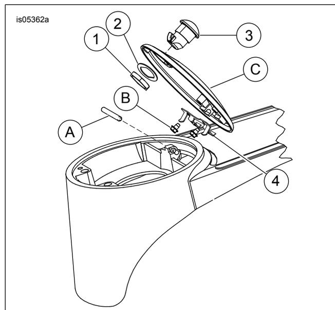
Figura 2. Parti di ricambio: Pulsante consolle per apertura sportello del combustibile
