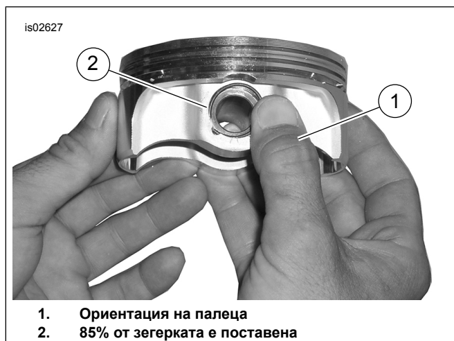
Фигура 3. Монтаж на зегерка (показано е нормално бутало)
