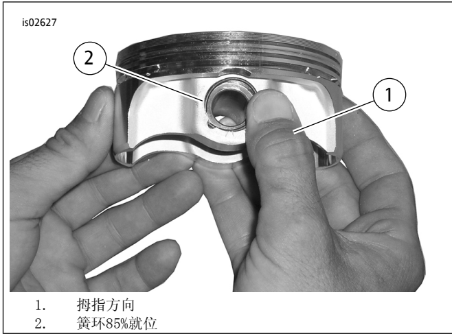
图3。安装簧环（显示的为通用活塞）
