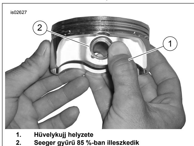
Ábra 3. Seeger gyűrű felszerelése (általános dugattyú látható)
