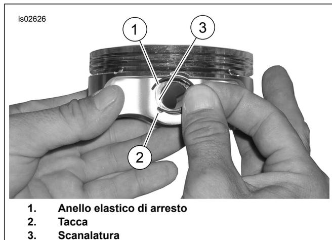
Figura 2. Anello di sicurezza e pistone (in figura pistone generico)
