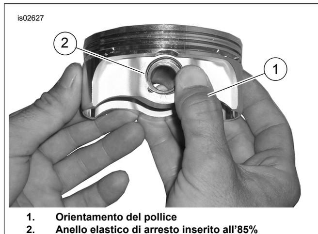
Figura 3. Installazione dell'anello elastico (in figura pistone generico)
