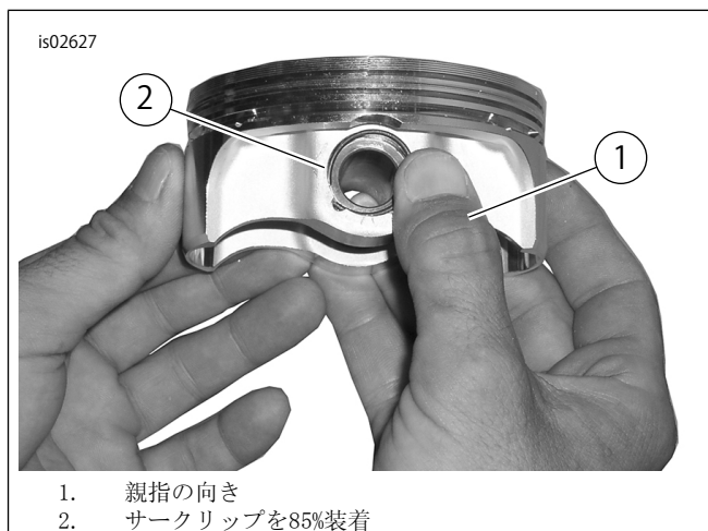
図3。サークリップを取り付けます(図示:一般的なピストン)
