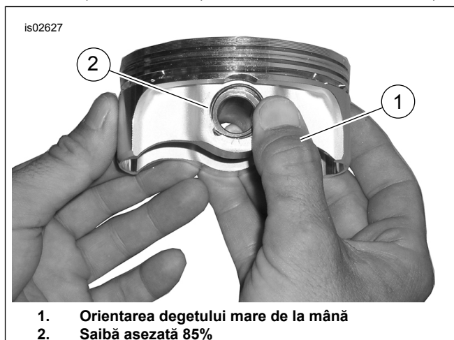
Figura 3. Montare șabă elastică (piston generic afișat)
