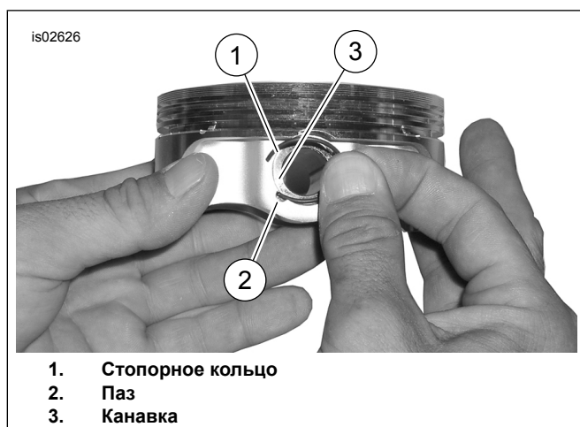
Рисунок 2. Стопорное кольцо и поршень (показан общий поршень)
