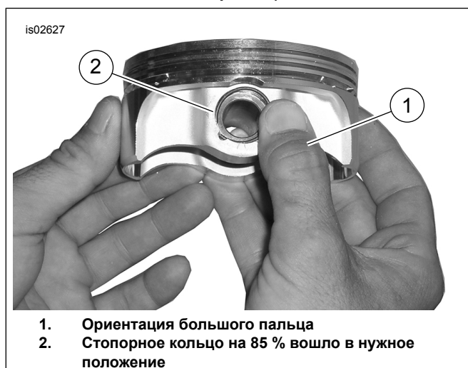
Рисунок 3. Установите стопорное кольцо (показан общий поршень)
