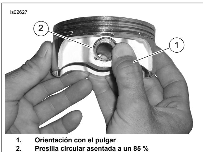
**Figura 3. Instala la presilla circular (se muestra pistón genérico)**
