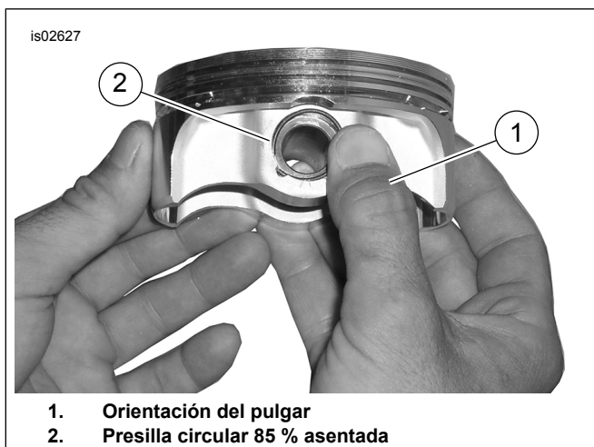
Figura 3. Instale la presilla circular (se muestra un pistón genérico)
