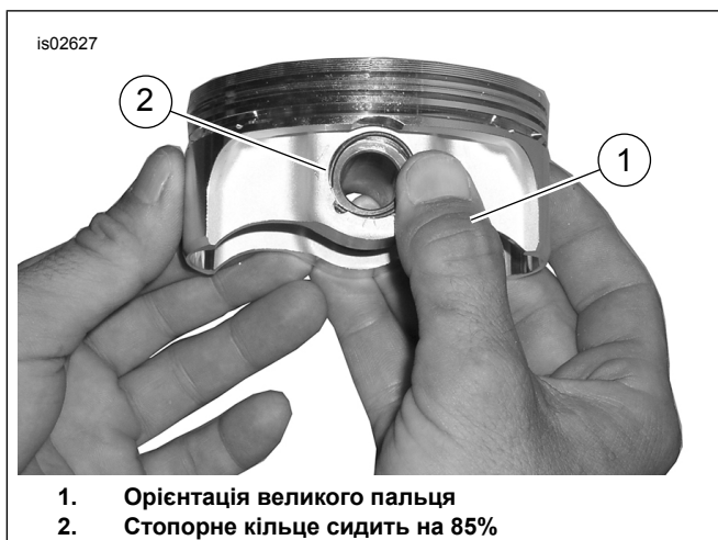
Малюнок 3. Установлення стопорного кільця (показано поршень взагалі)
