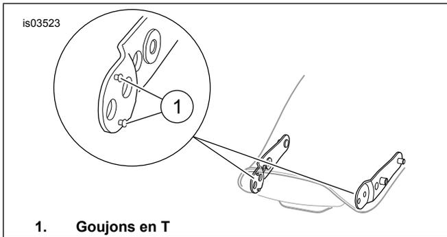
**Figure 3. Dépose des goujons en T**
