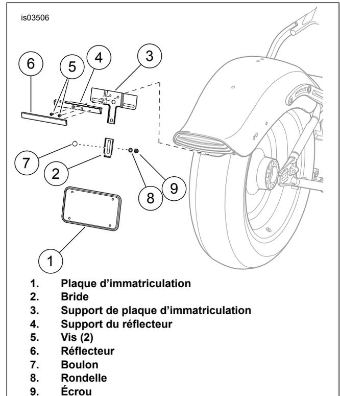
Figure 1. Dépose du support de plaque d'immatriculation et du réflecteur
