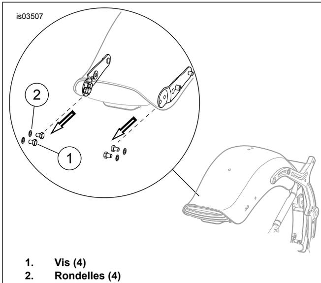
**Figure 2. Dépose de la vis et de la rondelle**
