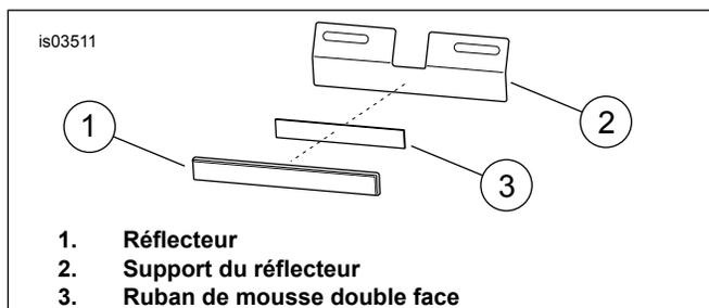
**Figure 6. Attache du réflecteur au support de réflecteur**
