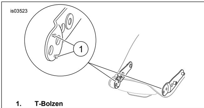
**Abbildung 3. Ausbau der T-Bolzen**
