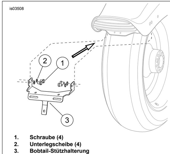
**Abbildung 4. Einbau der Bobtail-Stützhalterung**
